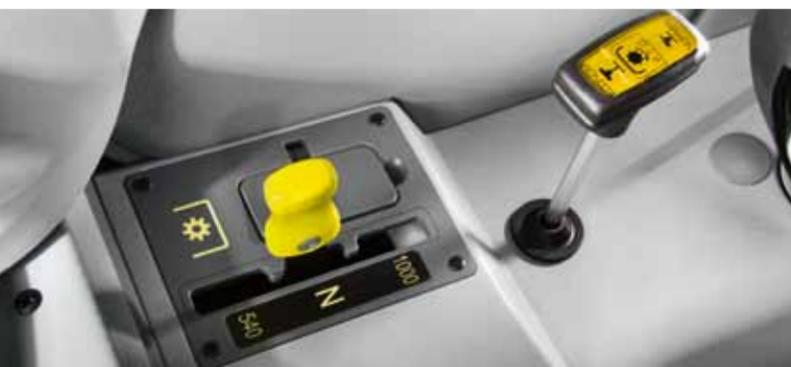
Présélection confortable en cabine de quatre régimes de Pdf.
