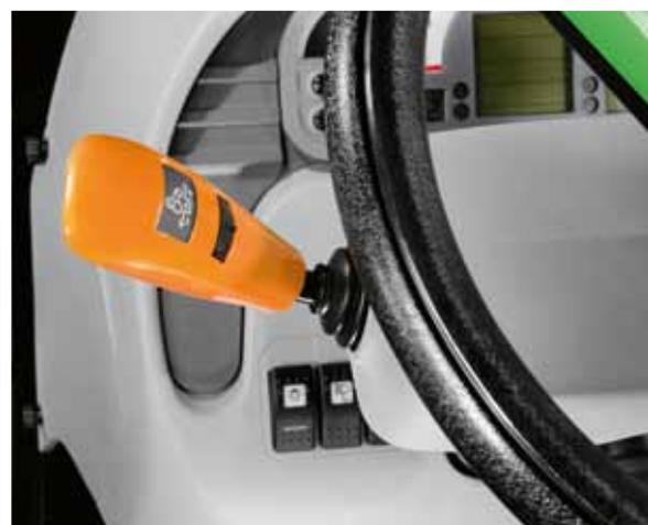
L'inverseur hydraulique Powershuttle à cinq niveaux de réglage fait des manœuvres un jeu d'enfant.
