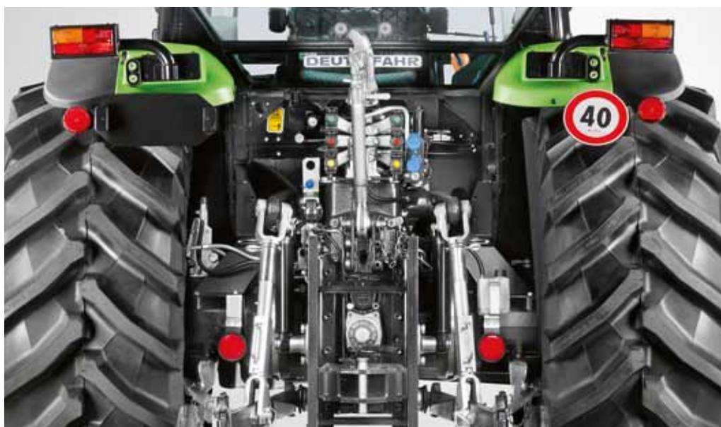
L'attelage arrière puissant offre une capacité de relevage atteignant 5300 kg adaptée aux applications les plus lourdes (6200 kg avec des vérins additionnels pour le modèle 430).
