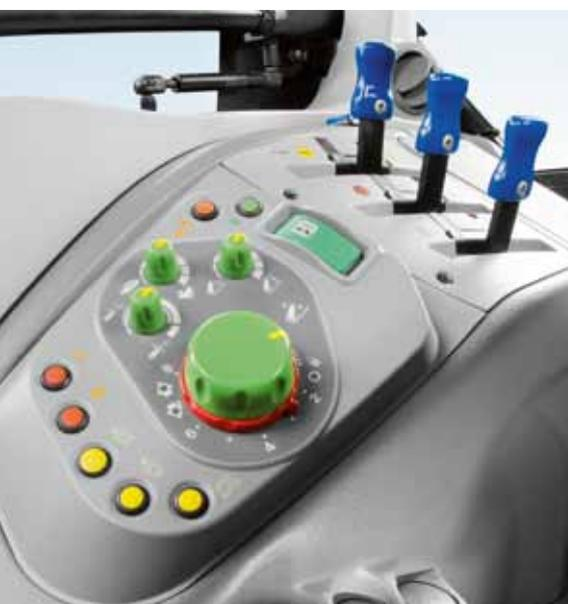
Relevage à commande électronique.
