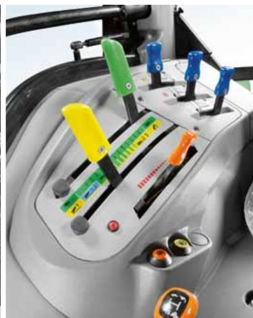
Commandes de relevage arrière mécaniques.
