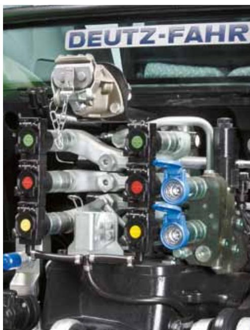
Raccords hydrauliques faciles d'accès et identifiés de manière claire. Jusqu'à quatre distributeurs sur demande.
