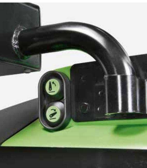
Commande externe du relevage électronique sur les deux garde-boue arrière.
