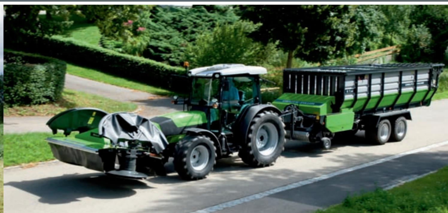
Avec sa hauteur de 2,38 m (selon modèle et pneumatiques) et associé à une remorque auto-chargeuse DEUTZ-FAHR de petit volume, l'Agroplus se faufile même dans les bâtiments d'élevage à portes basses.
