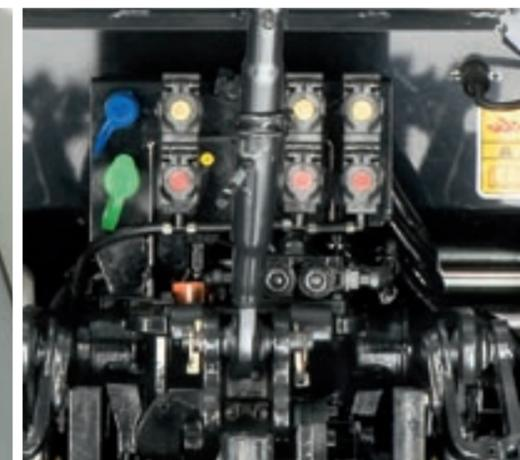
Extension des fonctionnalités hydrauliques: jusqu'à 3 distributeurs auxiliaires.
