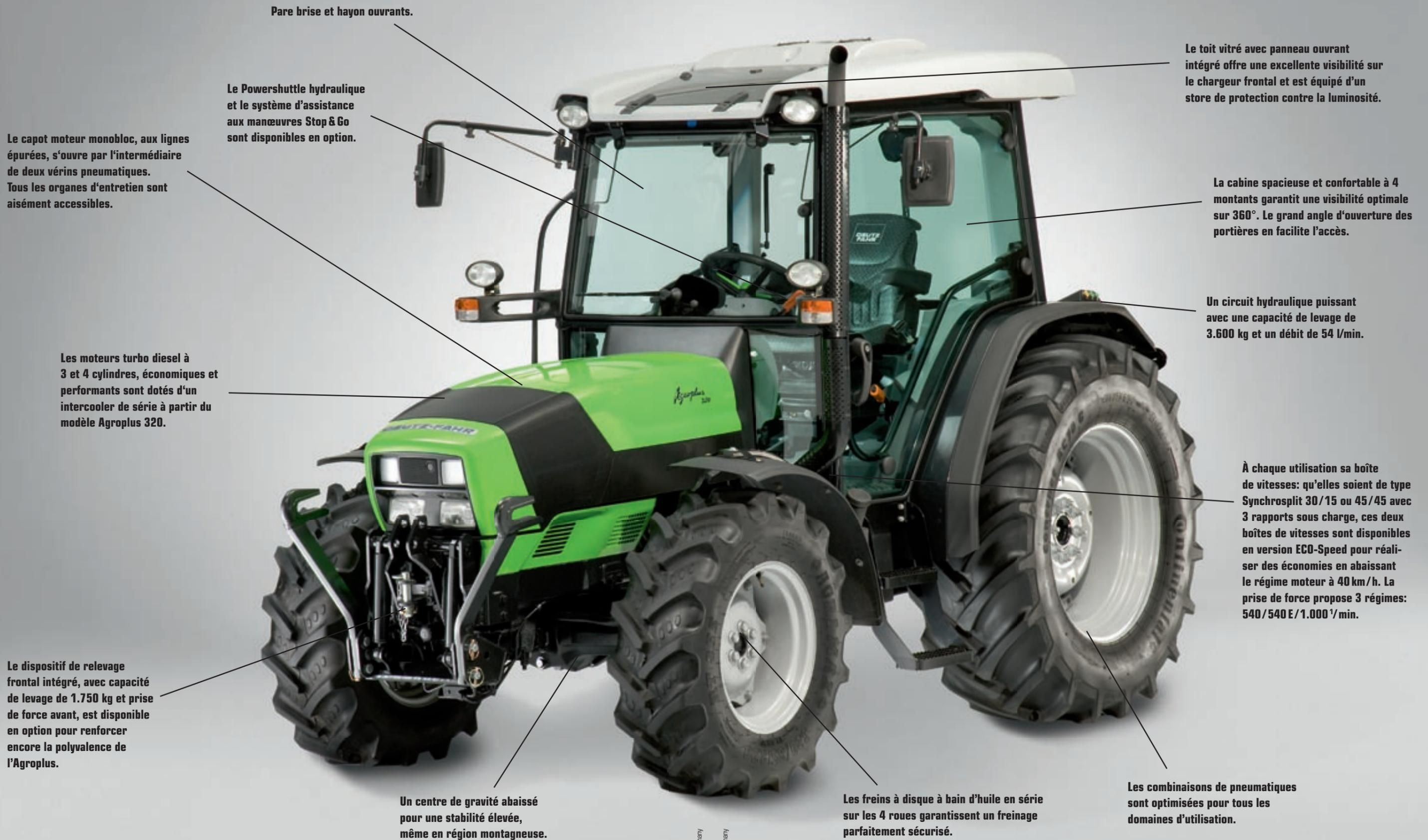
Le capot moteur monobloc, aux lignes épurées, s'ouvre par l'intermédiaire de deux vérins pneumatiques. Tous les organes d'entretien sont aisément accessibles.
