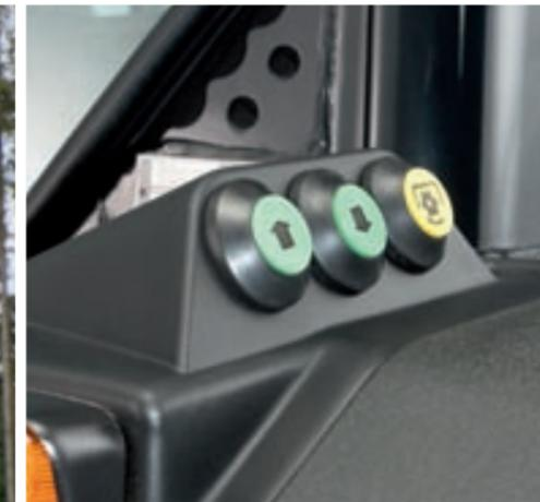
Tout sous la main, tout sous les yeux: la commande extérieure du relevage arrière
