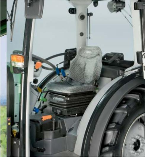
Le siège conducteur grand confort à suspension pneumatique ou mécanique.
