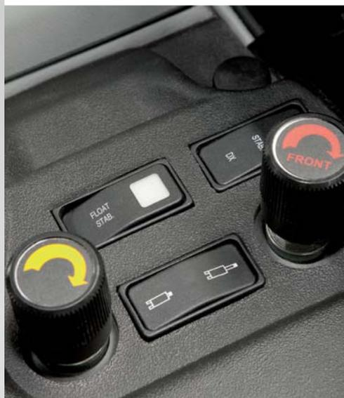
Les commandes de stabilisateurs, de chandelles électrohydrauliques et de régulation du débit pour les distributeurs auxiliaires.
