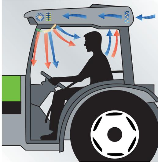
Chauffage, aération et climatisation (en option) sont installés dans le toit de la cabine.
