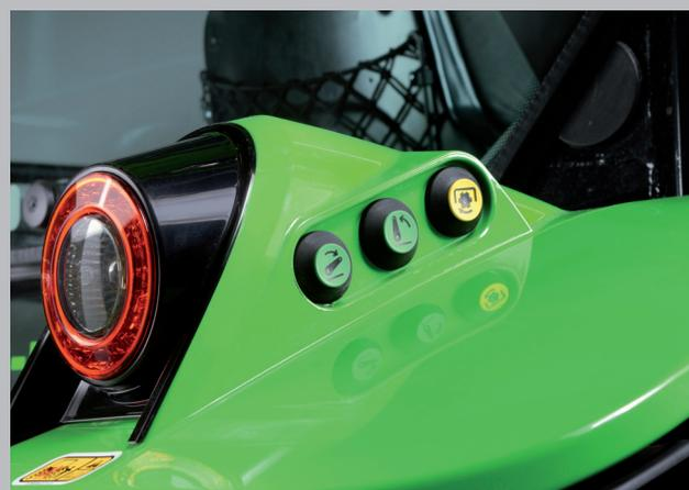
Commandes extérieures de relevage arrière et PDF pour l'installation directe des outils et l'opération extérieure de la PDF.
