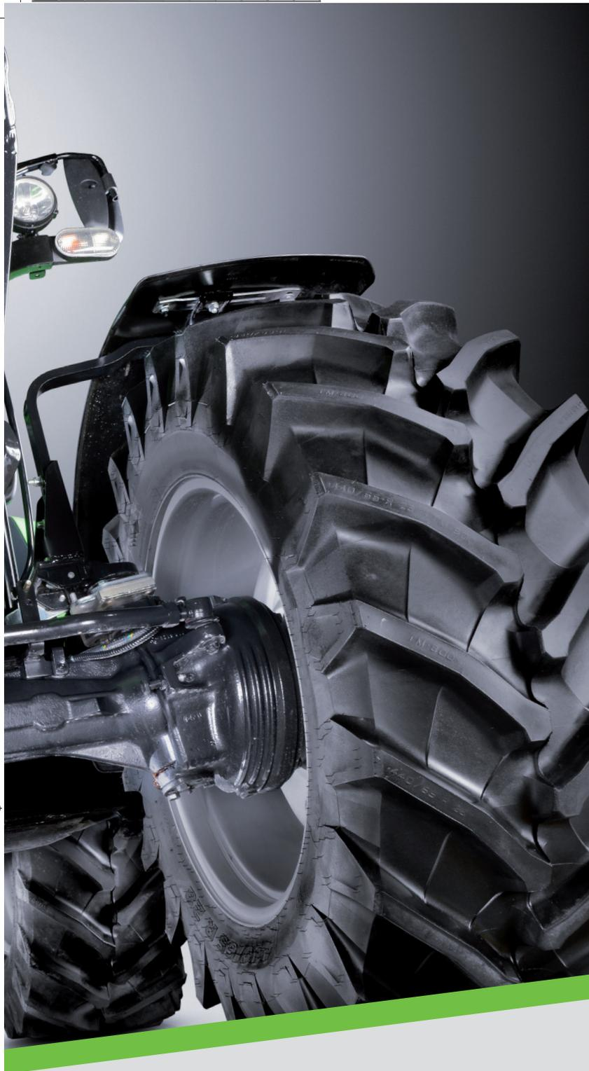
Le concept du pont avant de la nouvelle Série 5 assure confort de conduite, maniabilité, sécurité et traction en toutes conditions. Le capot compact garantit un angle de braquage de 55 degrés. Le système de direction rapide SDD, permettant d'effectuer la moitié du nombre de tours de volant nécessaires, est disponible en option sur tous les modèles. La sécurité est une priorité absolue pour DEUTZ-FAHR. Le pont avant tout comme le pont arrière sont dotés de freins à disque.
