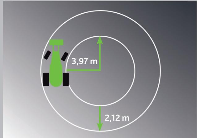
Un rayon de braquage de 3,97 m permet des manœuvres faciles dans les espaces les plus restreints (en fonction des pneus et des garde-boue).
